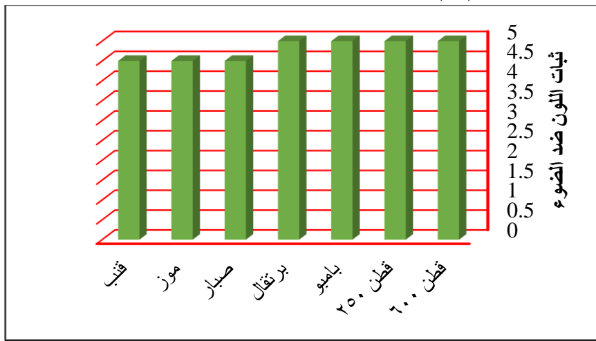
شكل (٢١) ثبات اللون للخامات (محل الدراسة) ضد الضوء
