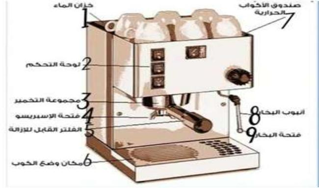
شكل (11) جهاز صنع القهوة
