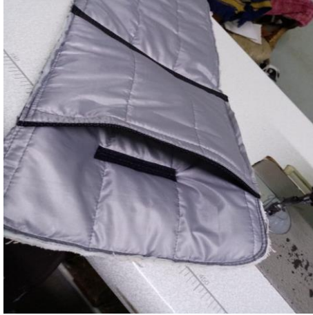
صورة ( 21 ) توضح تحضير الجسم الجانبي وتثبيته مع البطانة ويركب به الجيوب
