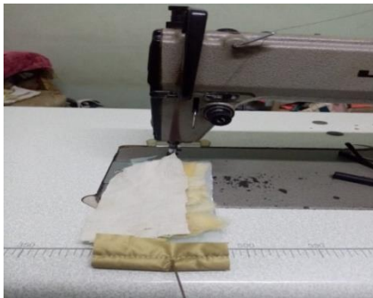
صورة ( 14 ) توضح الفايبر بين الطبقتين صورة ( 15 ) توضح الحياكة
