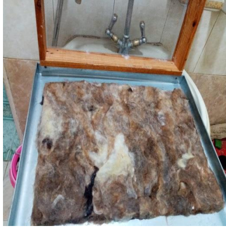
صورة (12) توضح رفع القالب من الحوض بعد التلبد
