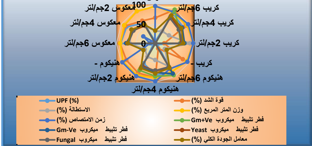
شكل (12) مقارنة جودة الأقمشة المنفذة باستخدام خامة (الفبران) ومادة المعالجة (الكيتوزان) مع العينة القياسية (القماش غير المعالج) بالنسبة للاختبارات
