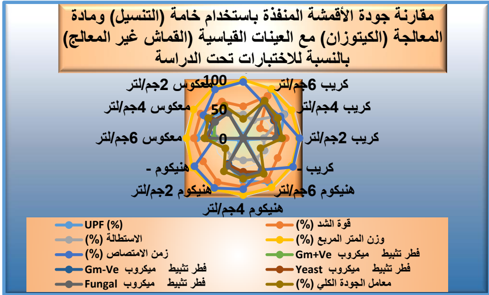
شكل (10) مقارنة جودة الأقمشة المنفذة باستخدام خامة (التنسيل) ومادة المعالجة (الكيتوزان) مع العينات القياسية (القماش غير المعالج) بالنسبة للاختبارات تحت الدراسة
