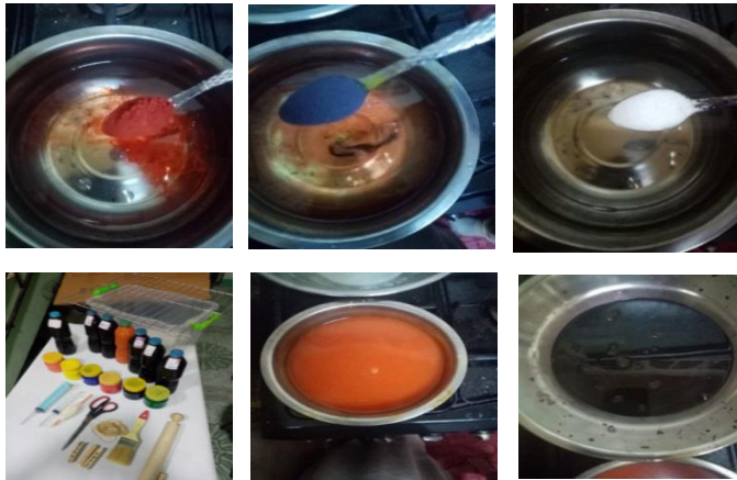
صورة (2) توضح خطوات تحضير محلول الصبغة المباشرة.
