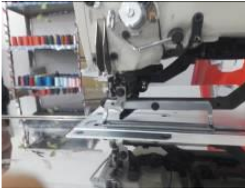
صورة (16) توضح مراحل تركيب مجموعة التغذية الخاصة بشق الباندا
