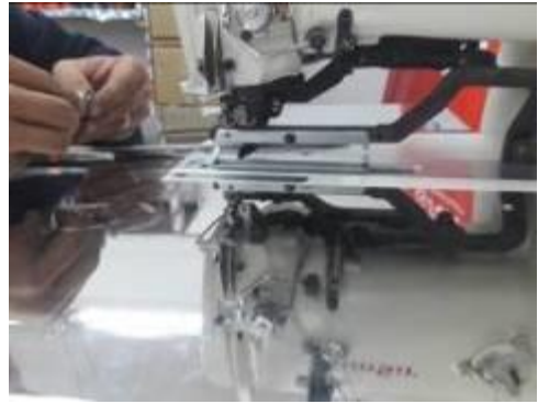
صورة (16) توضح مراحل تركيب مجموعة التغذية الخاصة بشق الباندا
