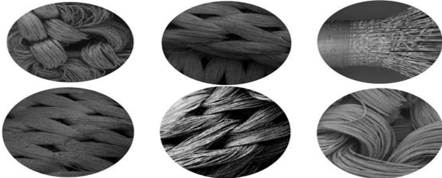
صور (26):(31) التركيب البنائي لشرائط التريكو الدائري المجوف (HKR) من السطح الخارجي
