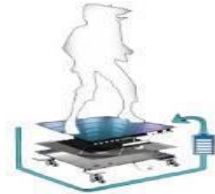
شكل (2) رسم تفصيلي للأرضيات المستخدمة لشحن الطاقة (6)
