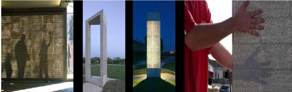
صورة (11) توضح شكل الخرسانة المضيئة (21)
