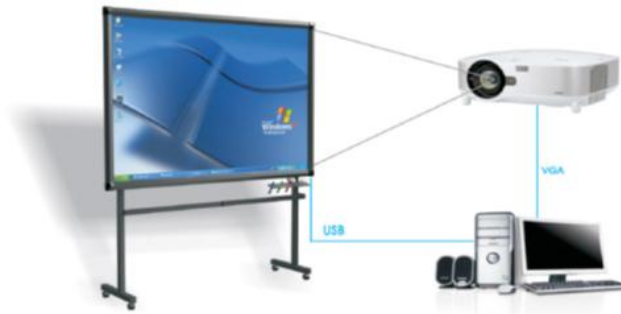
شكل (٤) طريقة تركيب السبورة التفاعلية
